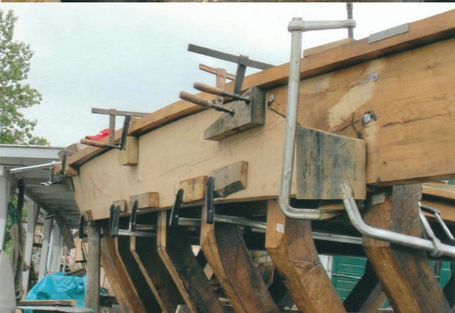
**Mit vielen Helfern wurden die bis zu 350 Kilos schweren Planken mit Zwingen und handgeschmiedeten Nägeln an die Spanten gebracht.**
